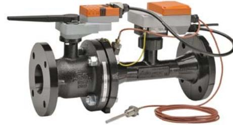
**IMPORTANTE:** El sensor de caudal se encuentra incorporado en su alojamiento. Para retirar el sensor se debe reducir la presión del sistema, drenarlo y/o cerrar directamente la válvula corriente arriba y abajo. El sensor y los cuerpos de las válvulas no deberán desarmarse y/o retirarse usando el actuador o el sensor de caudal. El desmontaje y/o retiro usando el actuador o sensor de caudal puede dañar los componentes de la válvula y anulará la garantía.
