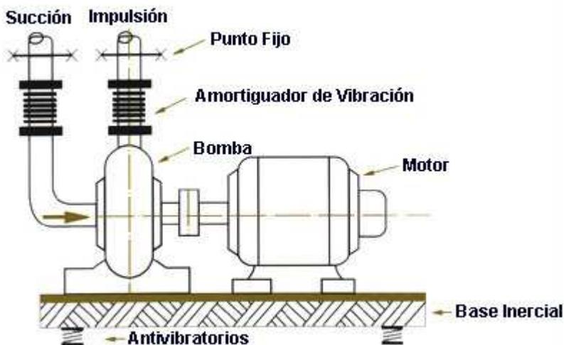
Para la correcta instalación, debe colocarse el amortiguador lo más cerca posible de la fuente generadora de vibración y fijarse el otro extremo mediante un anclaje o punto fijo bien robusto. De esta forma la vibración no se trasladará al resto de la instalación.
